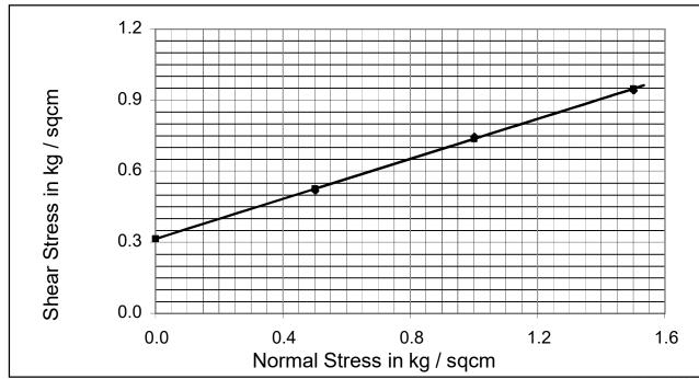
Cohesion  $C_u$  kg /cm<sup>2</sup> : 0.314 Angle Of Internal Friction  $\phi^o$  : 22.90
