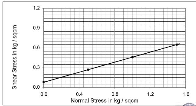
Cohesion C<sub>u</sub> kg /cm<sup>2</sup> : 0.079 Angle Of Internal Friction φ° : 20.8
